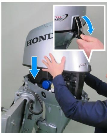
10. Laissez le capot du volant moteur de côté, puis reposez le capot moteur. Verrouillez les leviers de fixation du capot moteur.
