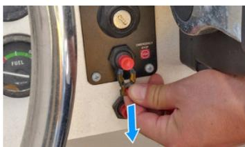
4. Retirez l'attache du commutateur d'arrêt d'urgence.
