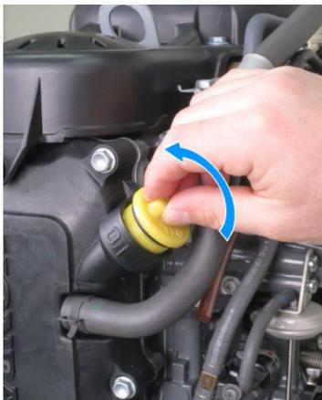
7. Retirez le bouchon du réservoir d'huile.
