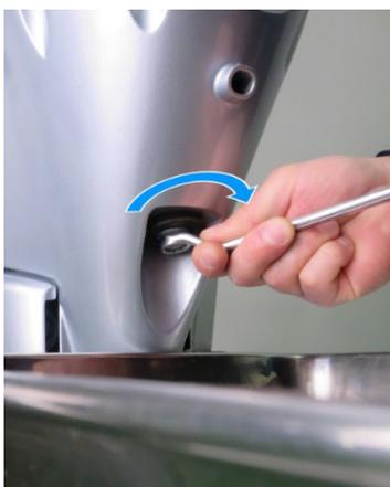
9. Après avoir vidangé l'huile, installez la vis de purge et une rondelle d'étanchéité neuve, et serrez bien la vis. Reposez le couvercle de vis de purge.
