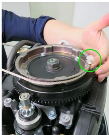
7. Sur le cordon du démarreur d'urgence, prenez l'extrémité comportant un nœud et insérez-la dans l'encoche du volant moteur.
