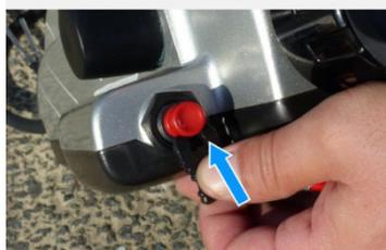
5. Insérez l'attache d'urgence dans le commutateur d'arrêt d'urgence. Fixez bien l'autre extrémité de la sangle du commutateur d'arrêt d'urgence à l'utilisateur. Mettez l'interrupteur du moteur en position ON (marche).
