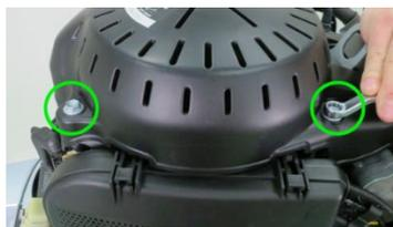
3. Retirez les quatre vis et le capot du volant moteur.
