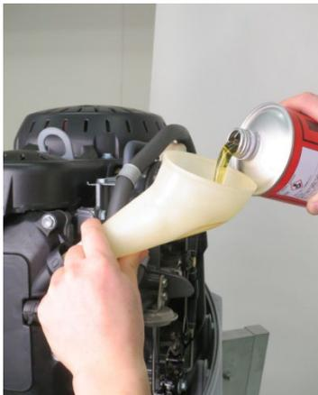
10. Remplissez jusqu'au repère de niveau supérieur sur la jauge de niveau d'huile avec l'huile recommandée. Ne remplissez pas trop. Une trop grande quantité d'huile peut nuire au moteur.
