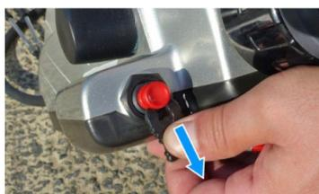
1. Retirez l'attache du commutateur d'arrêt d'urgence.
