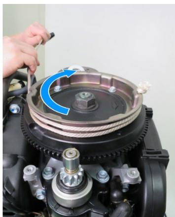
8. Enroulez le cordon du démarreur d'urgence dans le sens des aiguilles d'une montre autour du volant moteur le long de la rainure du volant moteur.
