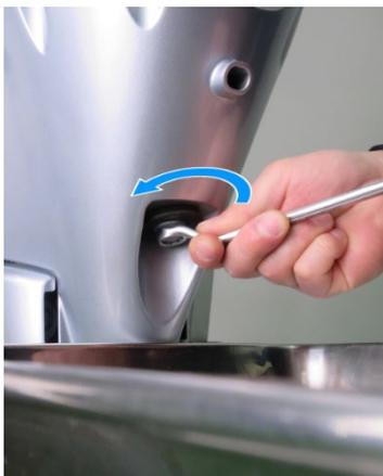
8. Placez un récipient adapté sous le guide de vidange d'huile, retirez le couvercle de la vis de purge, la vis de purge d'huile moteur et la rondelle. Vidangez l'huile moteur jusqu'à ce que l'huile usagée s'écoule goutte à goutte.
